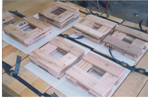
Probetas Normas UNNE 56-806/86 para impregnar
