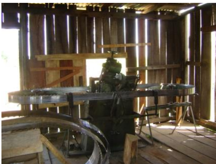
Foto N° 6: Equipo de afilado.
