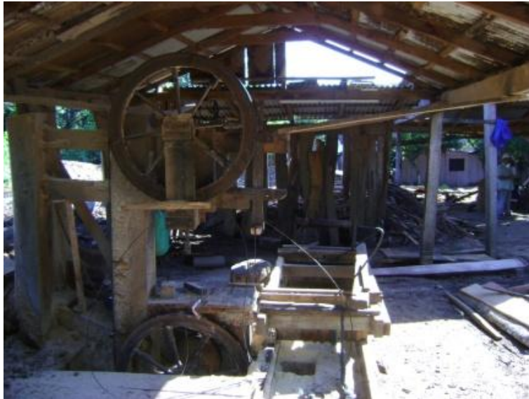
Foto N° 1: Sinfín vertical con piezas artesanales.
