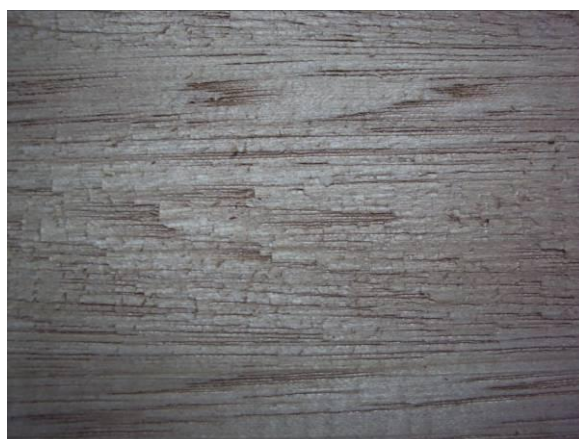
Figura 1 : Detalhes de grã arrancada no teste de plaina.
