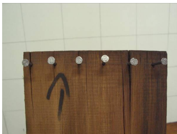
Figura 3: Ilustração do Fendilhamento de pregos em uma peça pertencente ao tratamento 215°C/4 horas.
