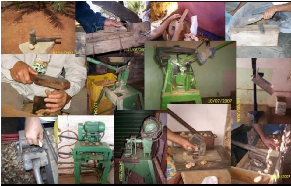
FIGURA 2 - Técnicas de quebra dos frutos: quebra com marreta; foice artesanal; lâmina e porrete; facão adaptado; machadinha fixada; quebradeira manual de baru; cópia da quebradeira; quebradeira com pedal; quebradeira automática; quebradeira elétrica de baru com lâminas horizontais; quebradeira elétrica de baru com lâminas transversais e as duas últimas são modelos semelhantes de quebradeiras manuais com apoio para as mãos, respectivamente.
