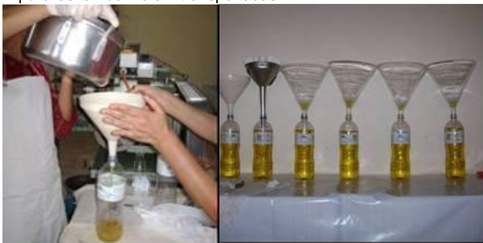
FIGURA 11 – Decantação e filtragem do óleo vegetal de baru.
