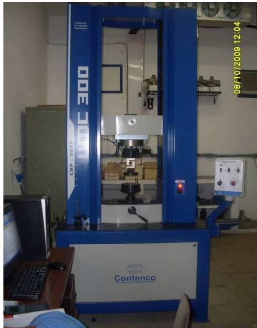
Figura 4. Máquina universal de ensaios Contenco UMC 300.
