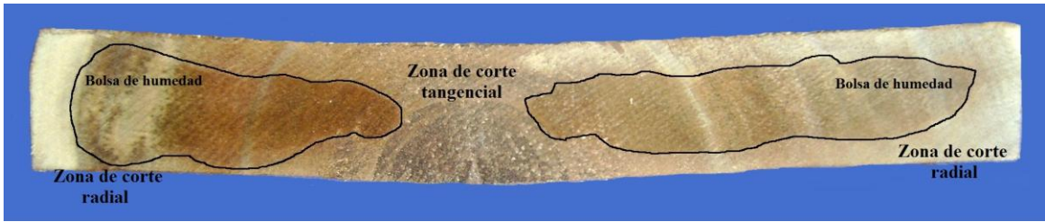
Figura 2. Bolsas de humedad presentes en la madera seca.
