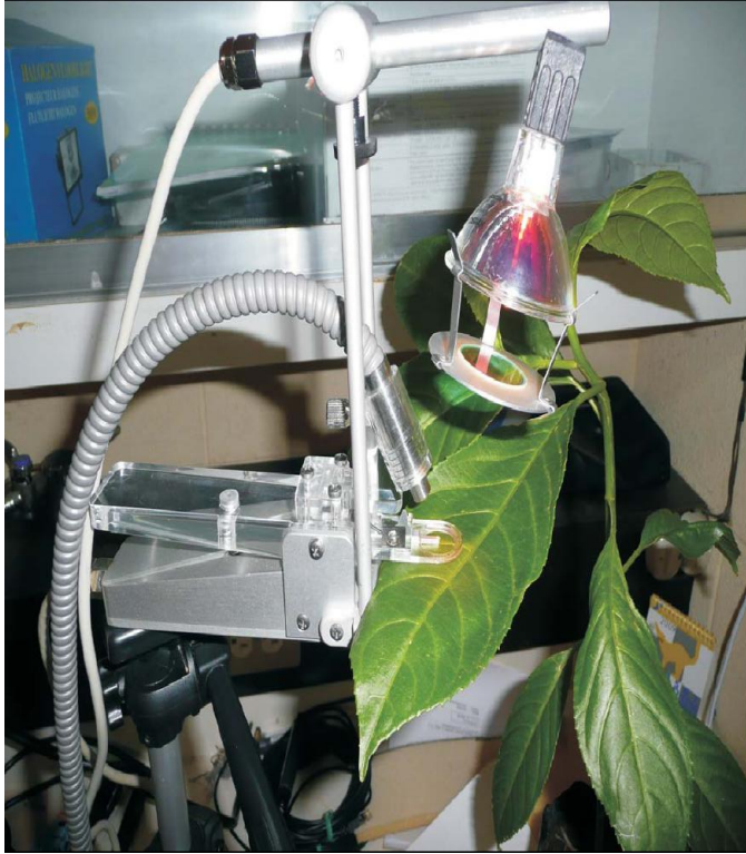
Figura 3. Medición de parámetro de Fluorescencia
