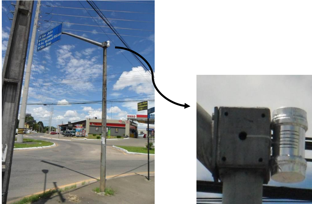
Figura 2. Exemplo de ponto de monitoramento e detalhe do mini-abrigo meteorológico utilizado
